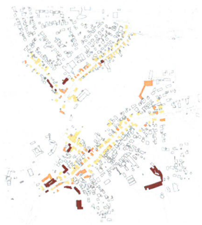
Zustand der Gebäude Marktgemeinde Mitwitz Maßstab: 0 m 200 m ■ im Umbaufaß ■ guter bis sehr guter Zustand ■ bestimmte Mängel ■ Mängel im erheblichen Maaß © I S Dürsch Institut für Stadtentwicklung 28. April 2010
